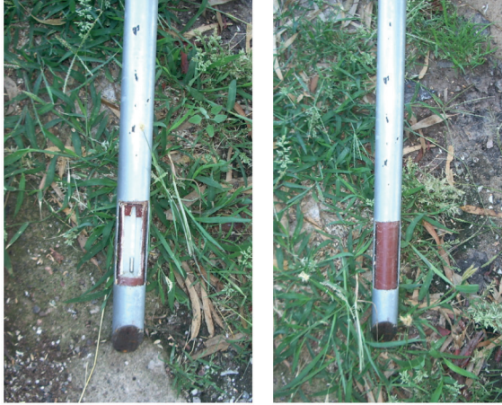
Figura 23. Lanza con sección móvil de medición. Termómetro al descubierto. Lanza con sección móvil de medición. Termómetro cubierto.
