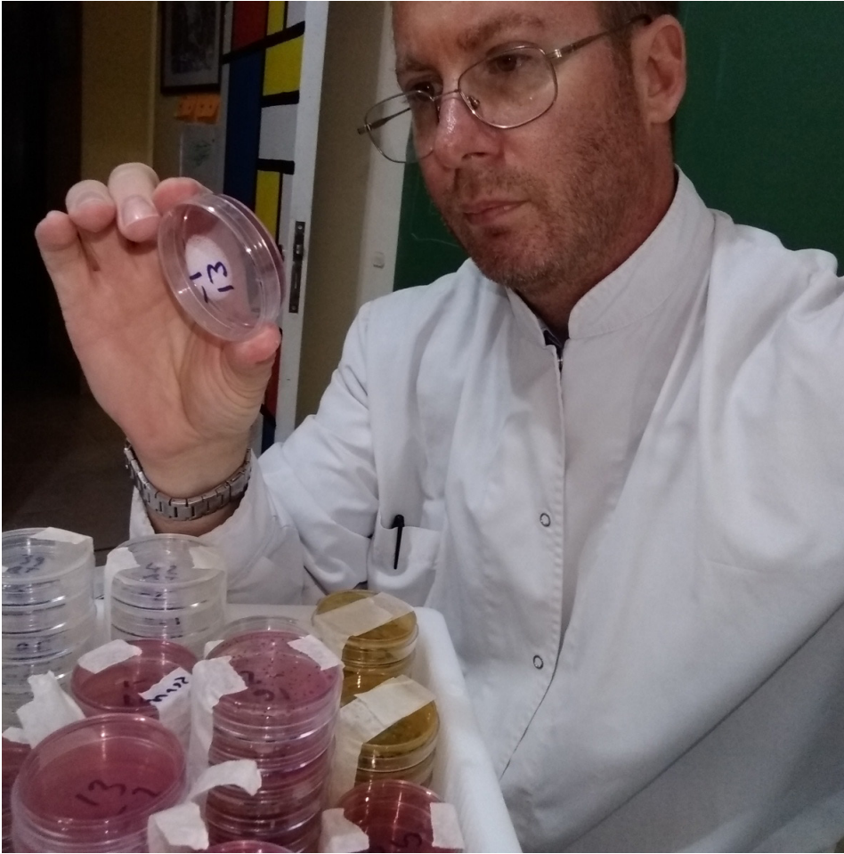
Ing. Zoot. Rubén Oliszewski Lectura de placas para enumeración de bacterias totales en leche. LACALAC (Laboratorio de Calidad de Lácteos - FAZyV, UNT). Tucumán, Argentina
