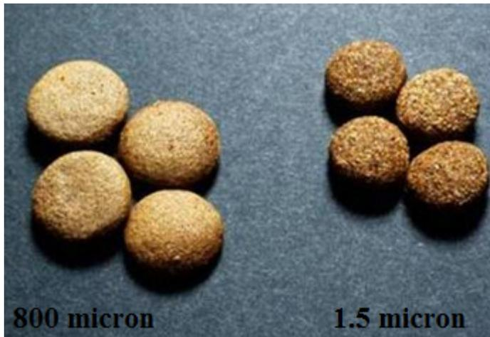
Figura 20.- Pellets elaborados con formulaciones con tamaño de partículas de  $800\ \mu\text{m}$  y  $1.5\ \mu\text{m}$ , respectivamente.
