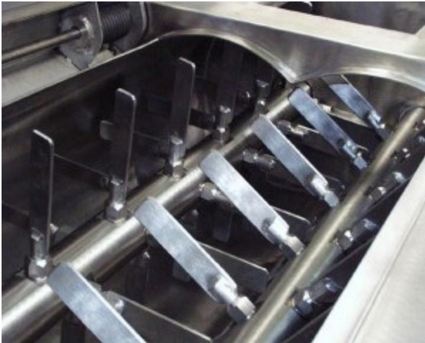
Fig. 5. Parte interna del pre-acondicionador CLEXTRAL®
