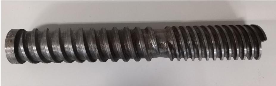
Figura 8.- Tornillo de una extrusora de cilindro corto de una sola pieza de alta velocidad de cizallamiento, normalmente utilizada en la extrusión de sémola de maíz.
