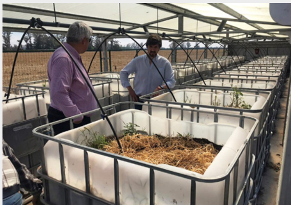
Imagen 3. Cama Biológica Indirecta con sistemas de biofiltros, ubicados en las instalaciones de Agrícola Testa S.A., en Pergamino, Bs As. Modelo PHYTOBAC de BAYER. Fuente: CASAFE.
