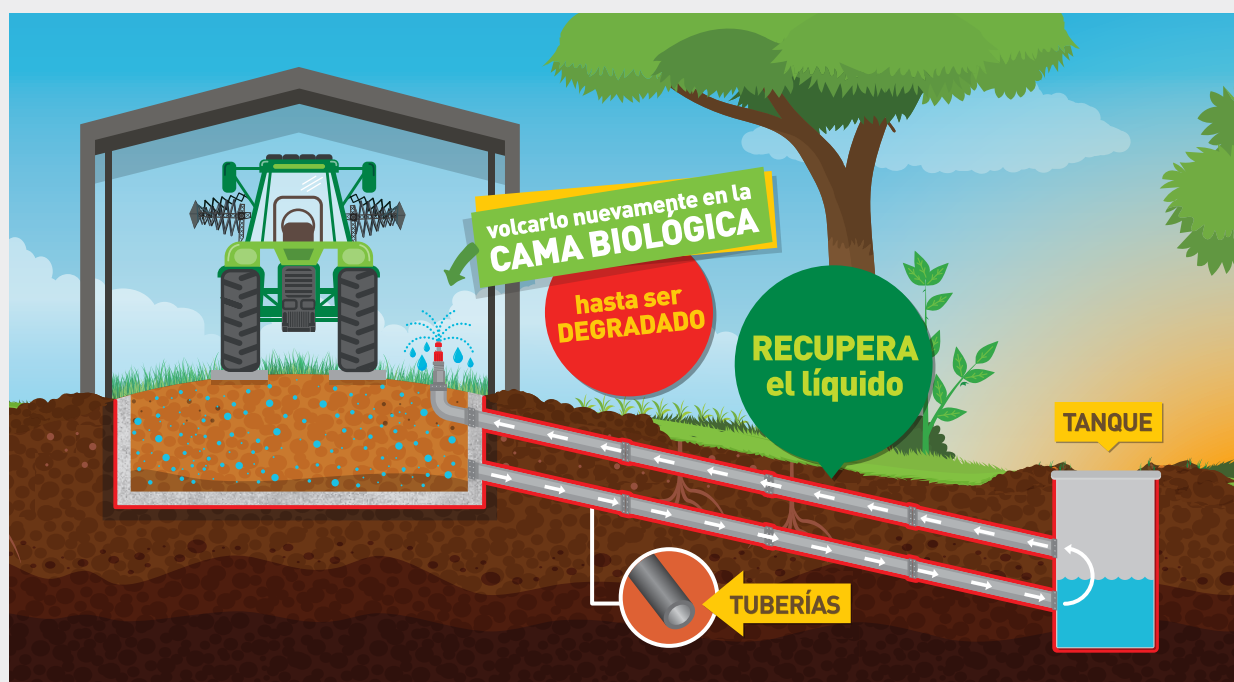
Figura 14. Esquema de una Cama Biológica Directa Abierta o con recirculación. Fuente: Manual Uso Responsable de Productos Fitosanitarios. CASAFE, 2020.
